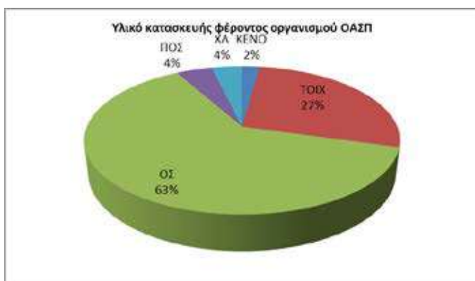
Διάγραμμα 7. Κατανομή κτιρίων σύμφωνα με το υλικό κατασκευής του Φέροντος Οργανισμού ΒΔ ΟΑΣΠ-2020
