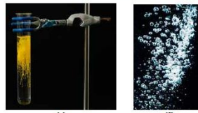
Εικόνα 5.27: (α) Καταβύθιση ιζήματος \text{PbI}_2 με τη μορφή χροστής βροχής. (β) Έκλυση αερίου \text{CO}_2 από τη διάσπαση ανθρακικών αλάτων με τη μορφή ψαλλίσματος.
